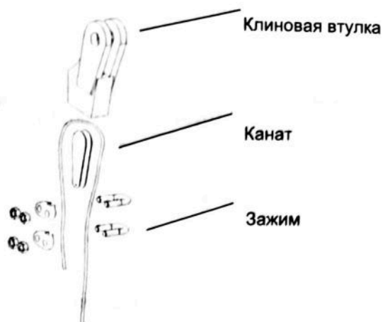
Крепление конца каната на барабане лебедки (слева) и на крюковой подвеске (справа)
